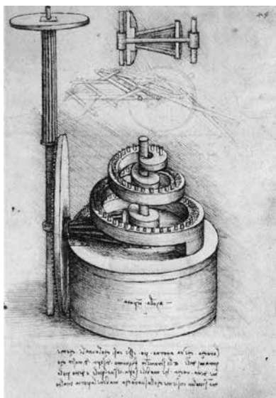
Bosquejo de Leonardo da Vinci sobre los mecanismos reguladores de la velocidad de rotación de un reloj
